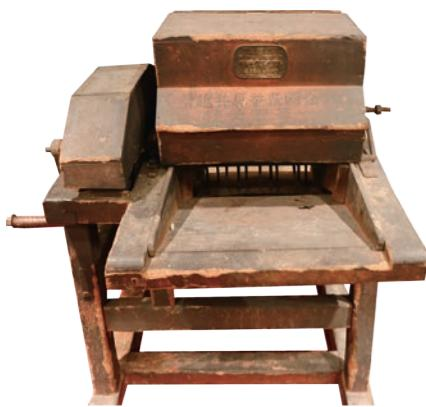
手廻し脱穀機：稻束を差込み、横のハンドルを回すと、稻束から粉が外れて落ちる仕組み
