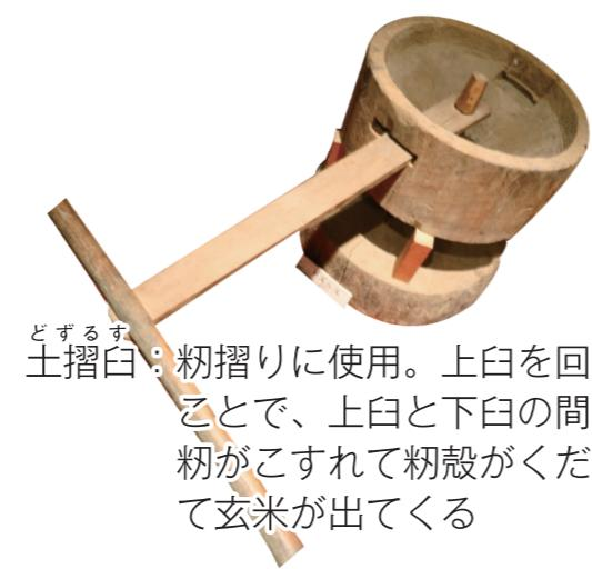
土摺臼：粉摺りに使用。上臼を回すことによって、上臼と下臼の間に粉がこすれて粉殼がくだけて玄米が出てくる
