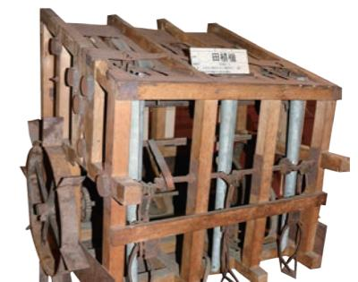
田植機：上の穴に苗をセットして転がすと、一度に3列分の田植えができる仕組み
